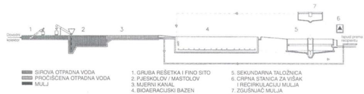
Grafički prikaz B-3: Postojeći UPOV Trilj – Shema tehnološkog toka
